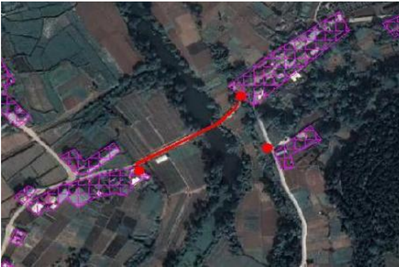
图 4-5 桥梁平面布置及线路走向图
